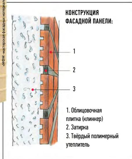
**1, 4, 7.** В подавляющем числе случаев для облицовки панелей используют клинкер. Это не только красивый, но и исключительно прочный и долговечный материал
