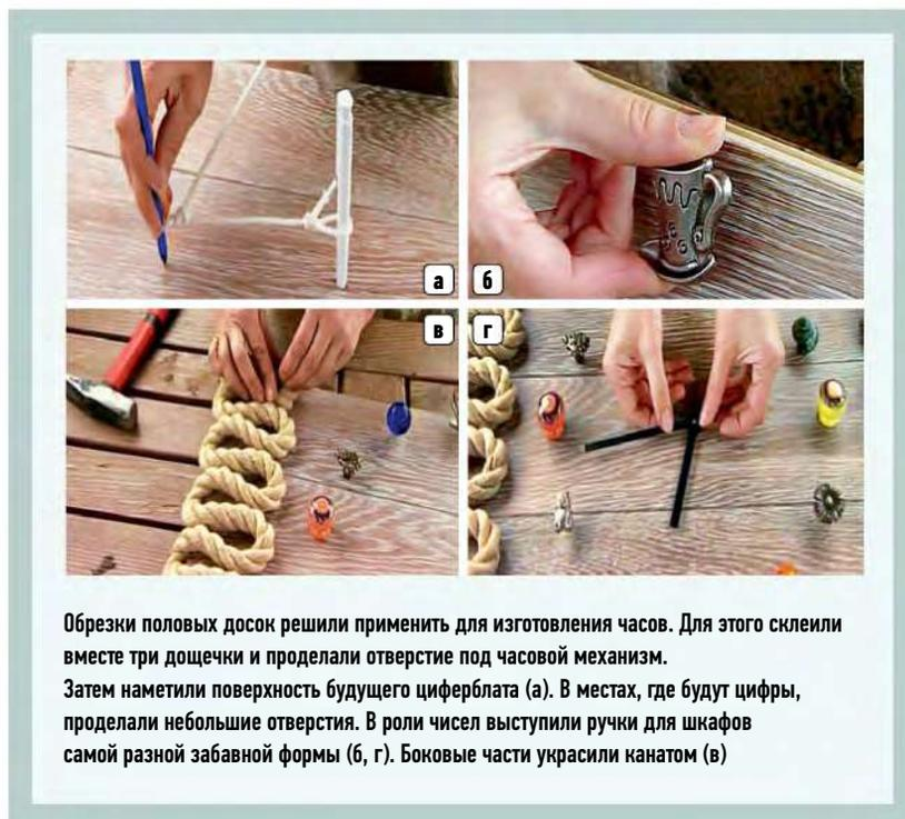
Обрезки половых досок решили применить для изготовления часов. Для этого склеили вместе три дощечки и проделали отверстие под часовой механизм. Затем наметили поверхность будущего циферблата (а). В местах, где будут цифры, проделали небольшие отверстия. В роли чисел выступили ручки для шкафов самой разной забавной формы (б, г). Боковые части украсили канатом (в)
